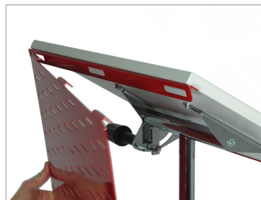
Die Zuschauerblende kann nach Bedarf in eine montierte Schiene ein- oder ausgehängt werden. Dadurch steht die Blende immer senkrecht – unabhängig von der Pultneigung.
